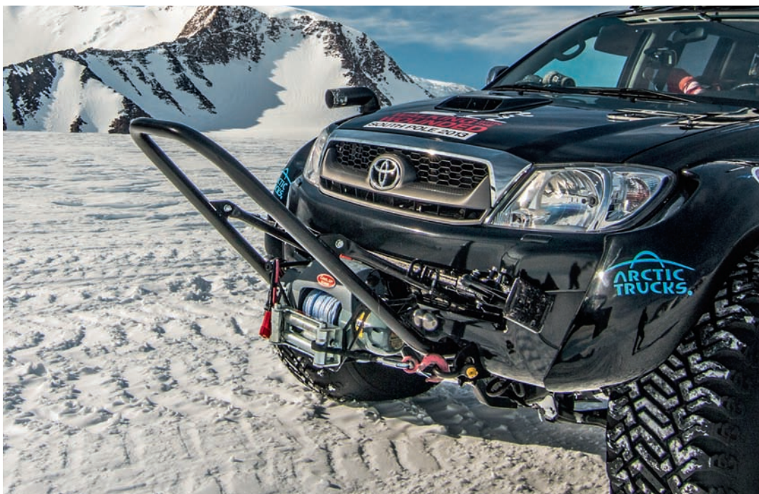
▲ ARCTIC TRUCKS 改装了汽车的车架、动力传动和车身, 加装了专用车胎以及各种各样的专业设备和配件, 并且配备了一套电气系统来应对严寒。
