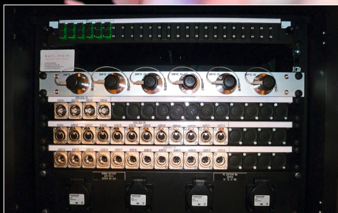
法国体育场外转播车的光纤连接台 ▶
