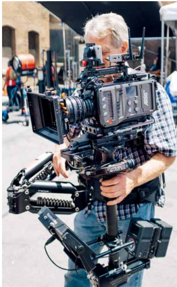
▲ M-1斯坦尼康配有“exovest”、支撑系统的杠杆臂以及帮助操作员稳定水平方向的Volt系统。
