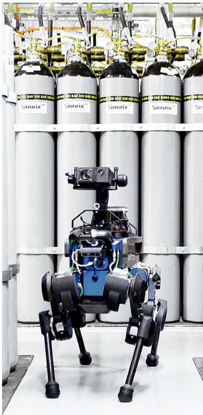
ANYmal可以检查各种物品的位置是否正确，读取计数器，检查气体泄漏或温度异常。
