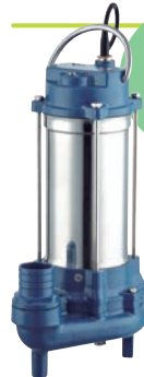
NATFLOW BOMBA PARA FOSAS SEPTICAS CON TRITURADOR 145782 Potencia 1.600 w. Caudal max18.000 l/h altura max. 15m. Cable eléctrico 10 mt. Altura min. succión 8 cm. En cuerpo de fundición y motor en acero inox.
