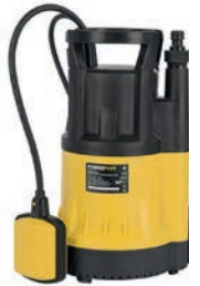
BOMBA SUMERGIBLE MULTIPLES ETAPAS 145958 750 W con hélices dobles. Bombea una altura de 22 m. Caudal máximo de 3 200 l/h.
