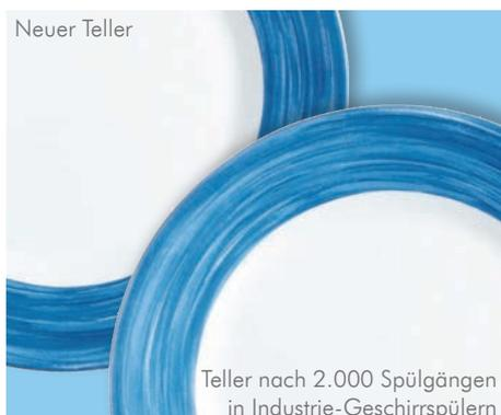
Alle Opalartikel mit Dekor werden über 2.000 mal industriell gespült und weisen danach keinerlei Beschädigung der Oberfläche auf.
