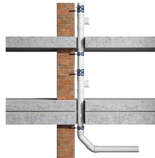
Fragment badanego w Instytucie Fraunhofera w Niemczech układu kanalizacji niskoszumowej AS+
