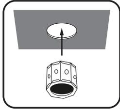
Perforación de un hueco en el plafón a la medida del luminario
