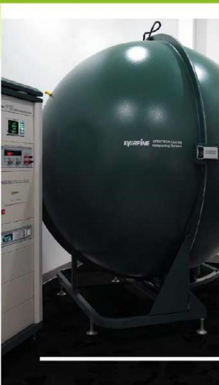
En México existen muy pocos laboratorios de pruebas de iluminación que cuentan con una esfera con estas dimensiones y capacidad, la esfera tiene la habilidad de medir luminarios y lámparas de LEDs, incandescentes y fluorescentes.
