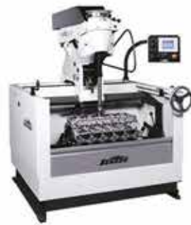
SV-10 Otomatik Dikey Honlama Çap Aralığı: 19 - 381 mm Parça Uzunluğu: 450 mm maks.
