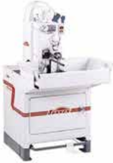
MBB-1660 Manuel Honlama Çap Aralığı: 1,52 – 165,1 mm Parça Uzunluğu: 400 mm maks.
