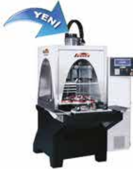
VSS 2 Tek Stoklu Honlama Sist. Çap Aralığı: 3,9 - 50 mm Parça Uzunluğu: 150 mm maks.
