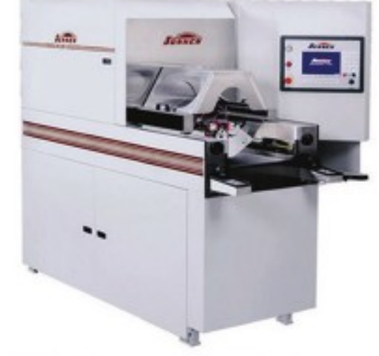
KGM Serisi CNC Honlama Çap Aralığı: 3,89 – 32 mm Parça Uzunluğu: 8 - 150 mm
