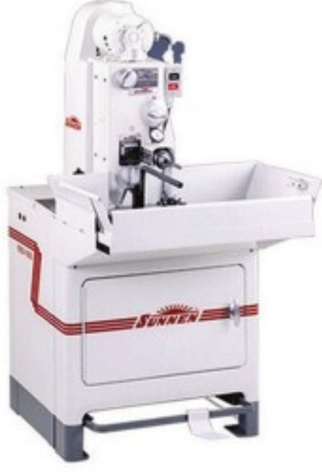
MBB-1660 Manuel Honlama Çap Aralığı: 1,52 – 165,1 mm Parça Uzunluğu: 400 mm maks.
