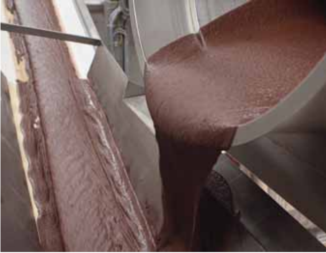
Ham karışım hadde makinesinde tekrar kavrulmaktadır
