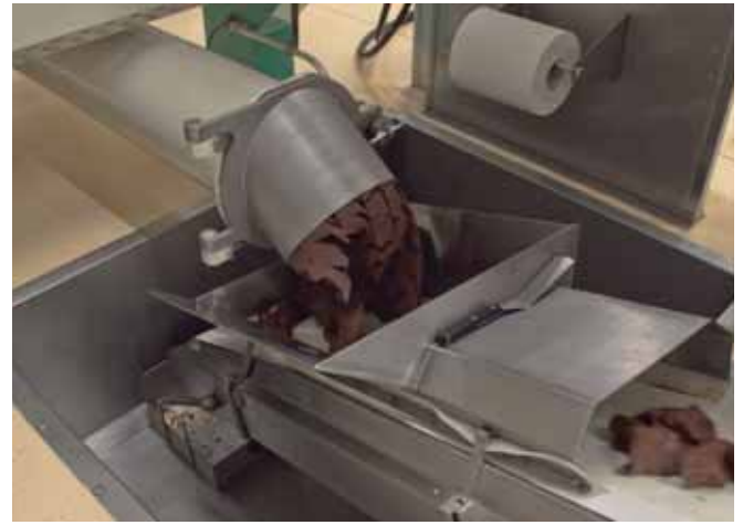
Kakao macunu helisel motorlu redüktörce tahrik edilen vidalı konveyör vasıtası ile sıkıştırılmaktadır
