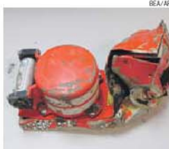
Esta caixa contém o Voice Cockpit Recorder
