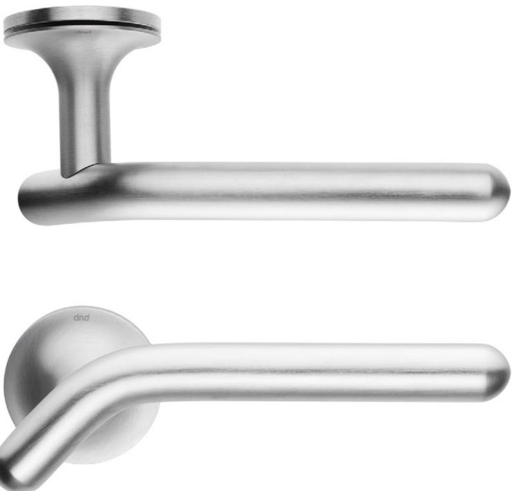
Una serie realizzata con una lavorazione dedicata e originale: un tondino di materiale viene tornito alle estremità e opportunamente inclinato di 45 gradi, per generare un gesto dinamico ed equilibrato sull'orizzontalità della leva.
