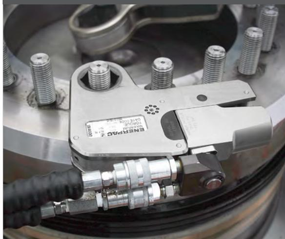
▲ *Um torquímetro hexagonal de perfil baixo W4000X aperta as cabeças dos cilindros durante as operações de manutenção.*
