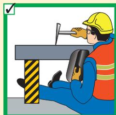
Com os macacos, nunca coloque qualquer parte do seu corpo sob a carga. A carga deve estar suportada mecanicamente antes de executar atividades embaixo da mesma.
