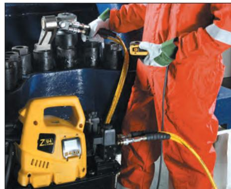
◀ Qualquer marca de torquímetro hidráulico pode ser acionada com a bomba portátil da Série ZU4.
