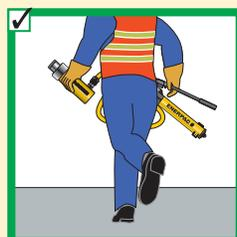
Não levante o equipamento hidráulico pelas mangueiras.
