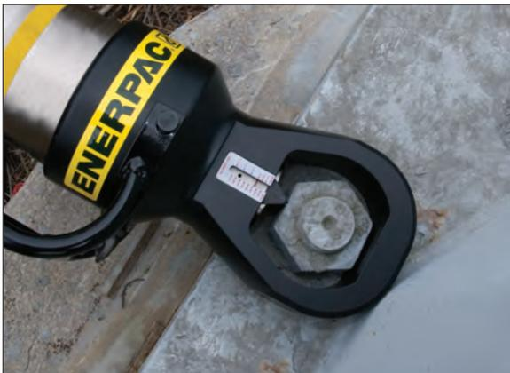
◀ Porcas severamente corroídas e desgastadas são rapidamente separadas e removidas, com o uso do Separador de Porcas da Série NS.
