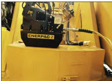
◀ *Reaperto das conexões aparafusadas em um guindaste com o torquímetro Enerpac S1500 alimentado por uma bomba para torquímetro ZU4.*
