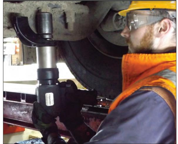
▲ *Manutenção segura e silenciosa do eixo com uma chave pneumática de torque..*
