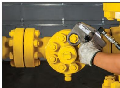
◀ *Torquímetro de perfil baixo W4000X em um flange de tubulação API.*
