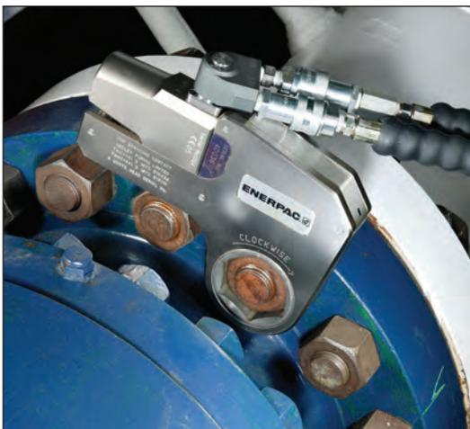
◀ A bomba ZE4 para Torquímetro se adapta perfeitamente a este Torquímetro W2000X.
