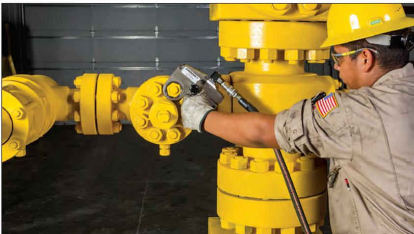
◀ *A maioria dos torquímetros hidráulicos pode ser acionada com a bomba pneumática para torquímetros Enerpac da Série ZA4.*
